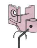
Regulación pernio inferior. Con un a llave allen de 2,5 mm se regula \pm 1 mm en el ancho.
